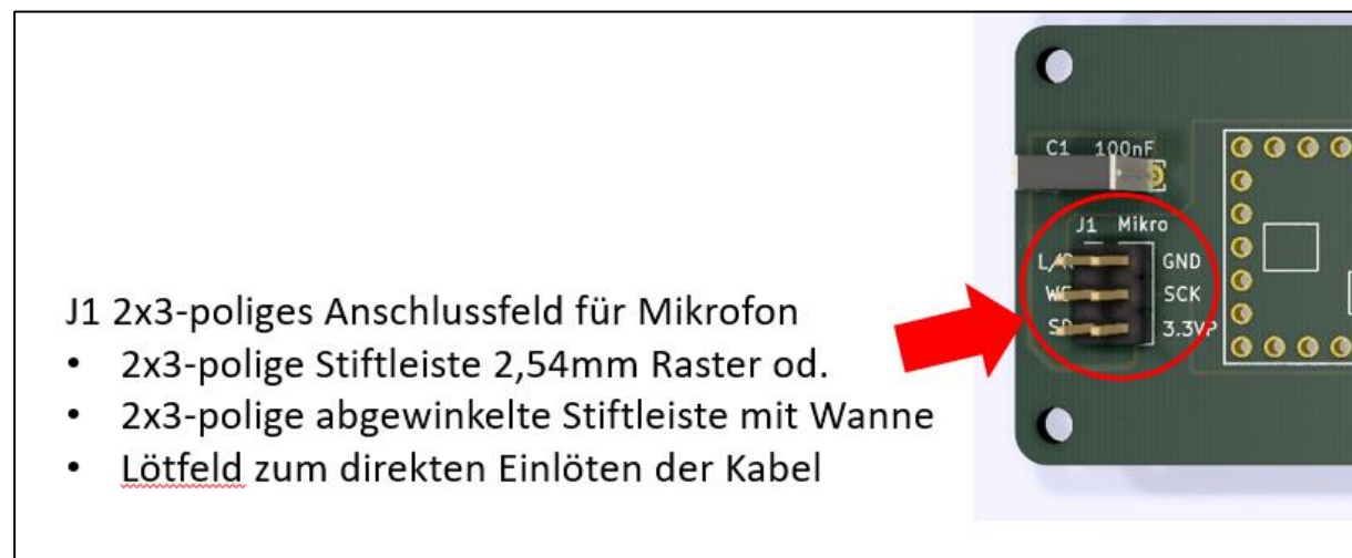
Abbildung 40 J1 2x3-poliger Mikrofon Anschluss
