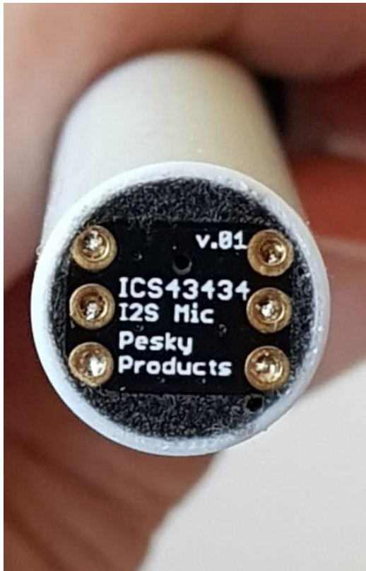
Abbildung 62 fertig ausgegossenes Mikrofonrohr
