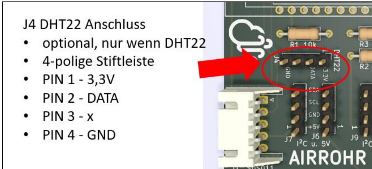
Abbildung 14 J4 DHT22 Anschluss
