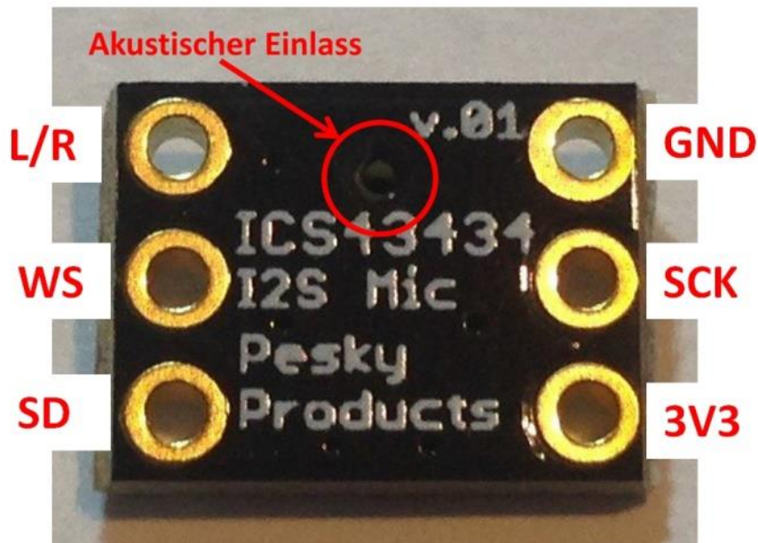
Abbildung 53 Pesky Board akustischer Einlass unbestückte Seite
