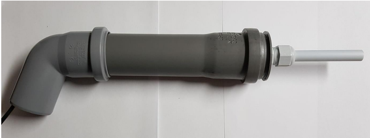
Abbildung 76 montiertes DN40/DN50 Gehäuse
