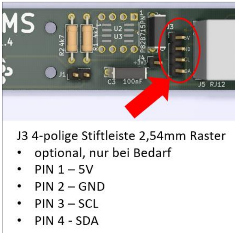
Abbildung 30 J3 I 2 C Anschluss (optional)
