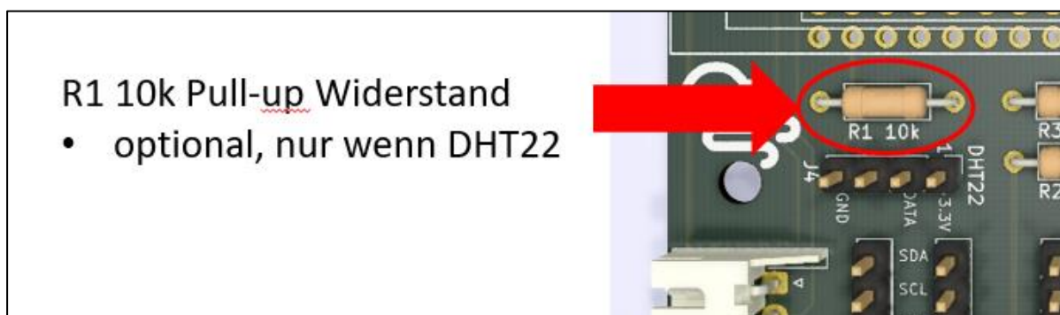
Abbildung 21 R1 10k Pull-up Widerstand für DHT22
