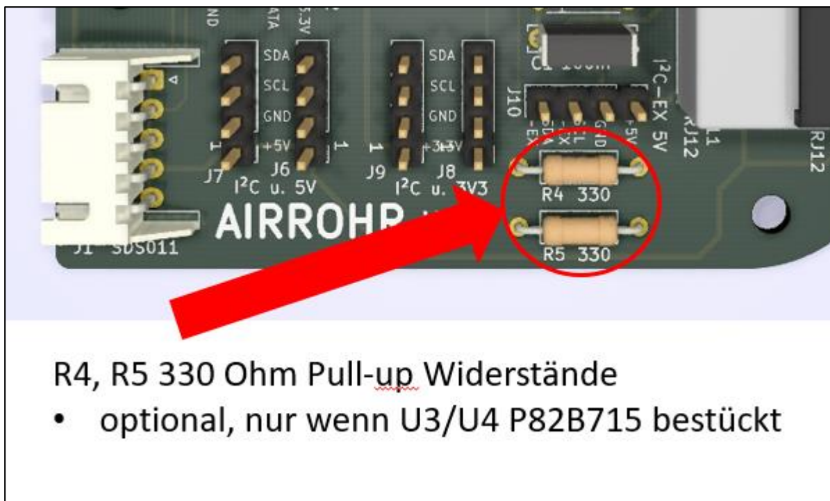
Abbildung 23 R4, R5 330 Ohm Pull-up Widerstände für I 2 C Extended Bus
