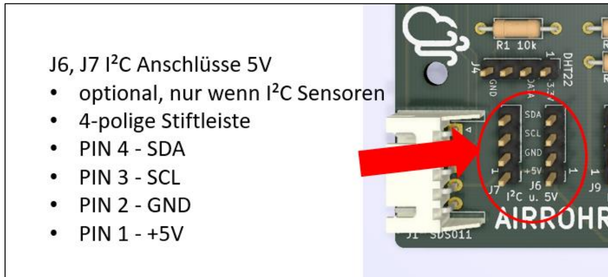
Abbildung 16 J6, J7 I 2 C Anschlüsse 5V
