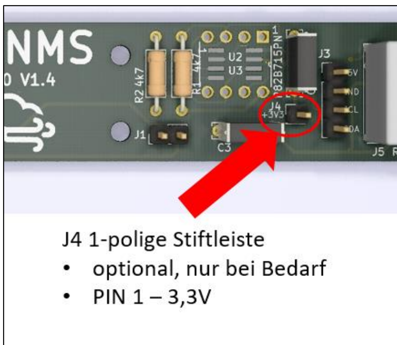
Abbildung 31 J4 3,3V Anschluss (optional)
